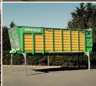
Použití výměnných nástaveb JOSKIN na podvozku TATRA PHOENIX.
